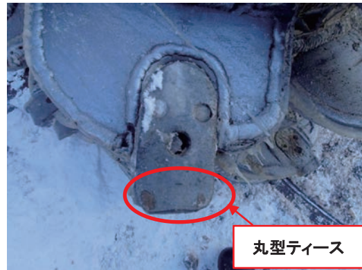
写真-11 合継手部に配置したカッターの歯
