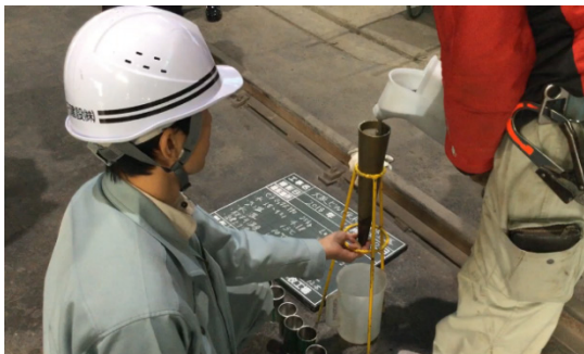
写真-7 ロート試験状況
