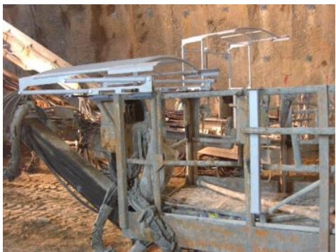
写真-4 ホイールジャンボ・バスケット落石防護
