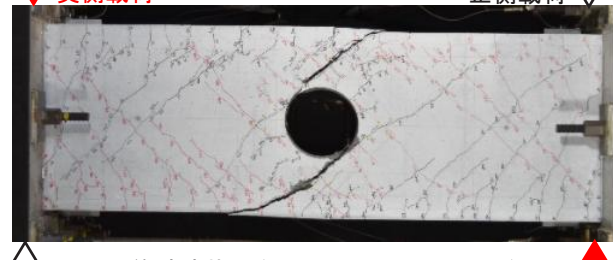
最終破壊状況 ( p_{wd1}=0.41\% , p_{wd2}=0.28\% ) 写真-4 試験体 No. 7 ひび割れ状況
