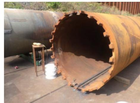
写真-5 先端ビット付き鋼管杭
