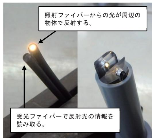
写真-12 光ファイバーセンサーの概要
