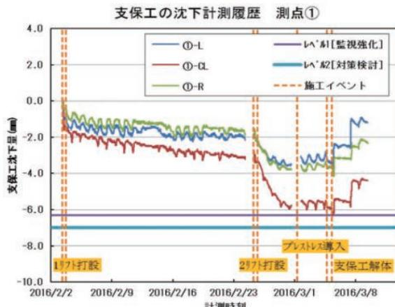
図-13 支保工沈下量の計測結果
