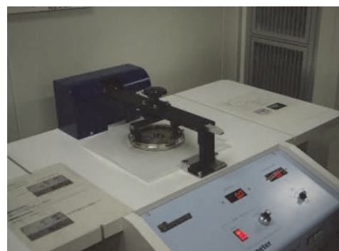
写真-8 通気性試験状況 (フラジール形法)
