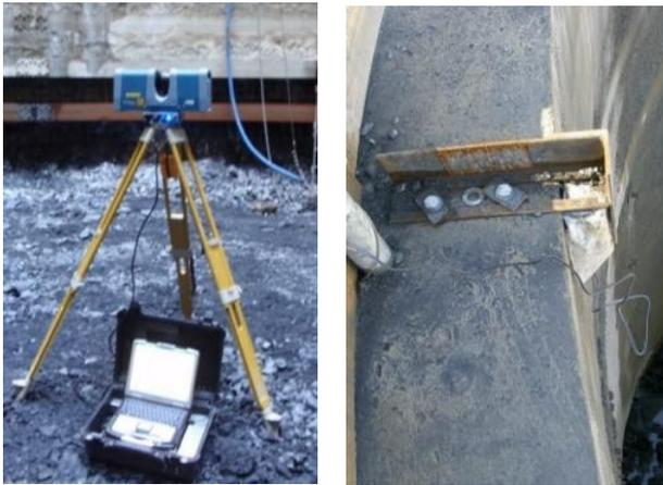
写真-2 3D スキャナーと鉛直レーザー
