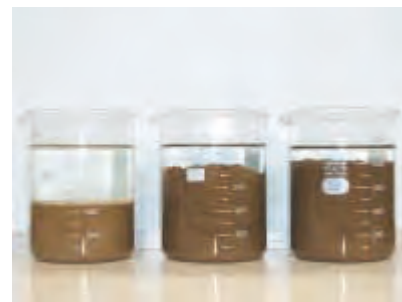
凝集剤を加えた泥土 （添加量による凝集効果の違い）
