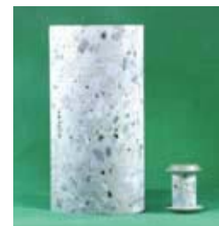
左:標準コア(直径10cm) 右:小径コア(直径2cm)
