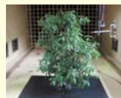
シラカシを用いた風洞実験
